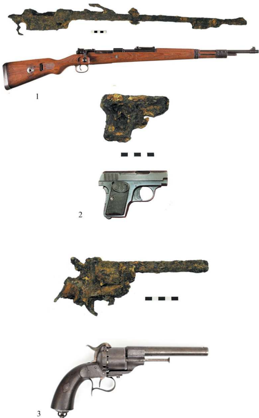
Рис. 40. Образцы оружия из городского слоя на уровне горизонта 1 (с коллекционными аналогами). 1 – ствол винтовки Mauser 98k образца 1898 г.; 2 – пистолет Browning M1906 образца 1906 г.; 3 – револьвер Lefauchaux M1858 образца 1858 г.
