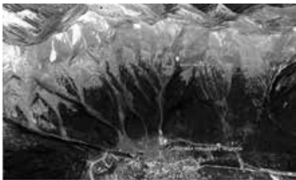
Рис. 7. Аул Архыз расположен у подножья южного склона хребта Абишира Ахуба. На снимке хорошо видны лавинные прочёсы на склоне хребта
