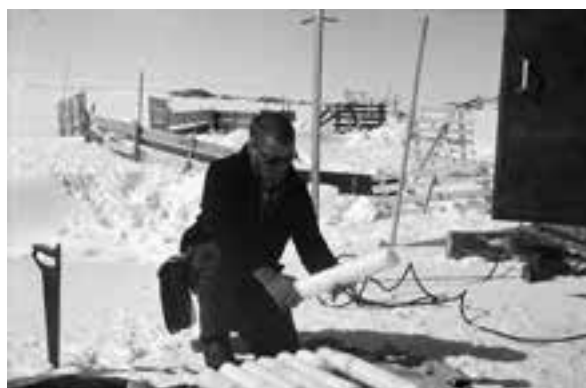
Ледяные керны, полученные при бурении льда, источник информации о структуре и особых свойствах морского льда
