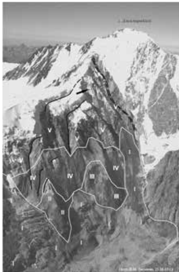
Условные обозначения — трещины отседания ■ ■ ■ — линии контакта, ограничивающего с запада толщу сильно трещиноватых вулканогенно-осадочных пород — участок формирования многофазного обвала в 2002 году
